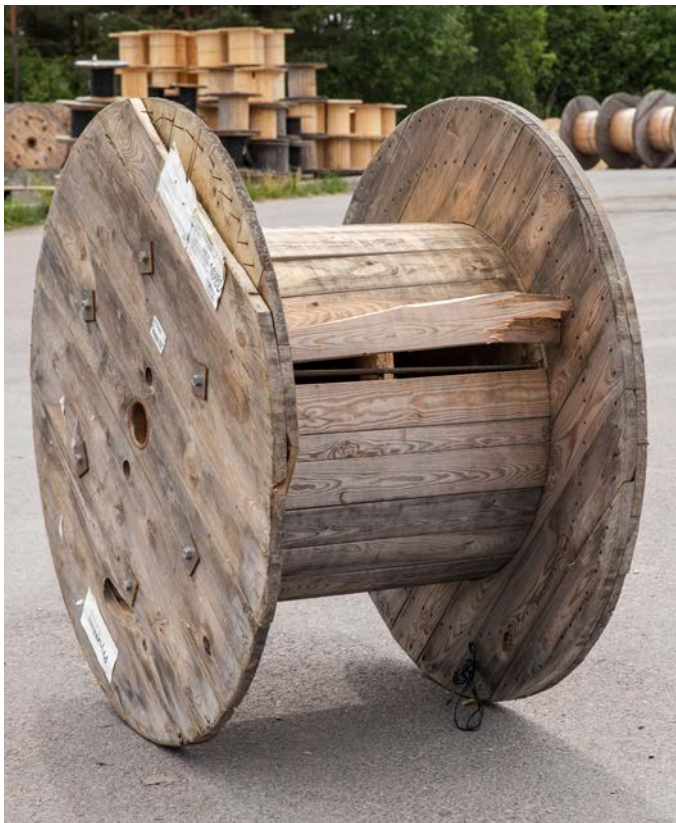
C Lauad on puudu või katki.
