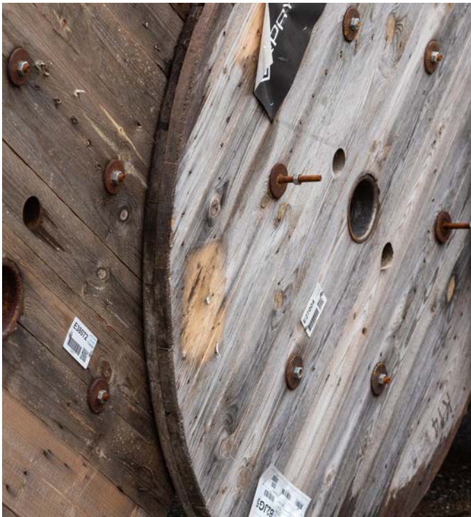
E Trumlil on metallosad defektsed või puudu.
